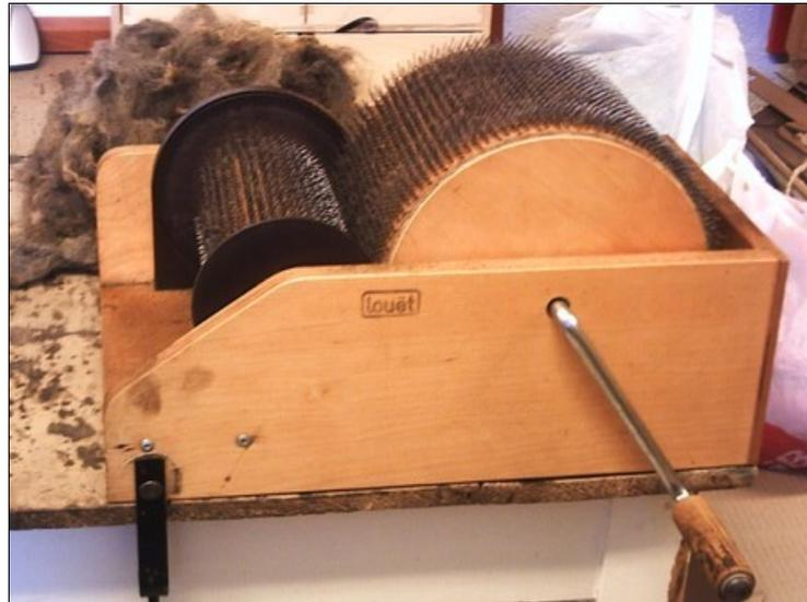
C'est une cardeuse louet, d'un modèle ancien, LA cardeuse des rooth spinners des années 70! Avec 4 aiguilles au cm<sup>2</sup> (et encore, des grosses!), elle est imbattable pour carder la toison en suint!
