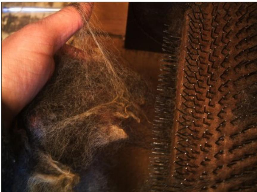
Je ne pose pas les mèches sous le petit rouleau, j'accroche quelques fibres aux aiguilles du dessous et je tourne la manivelle pour que ca accroche. En même temps, j'ouvre les mèches avec ma main et je tire un peu en arrière pour ouvrir la laine au mieux.
